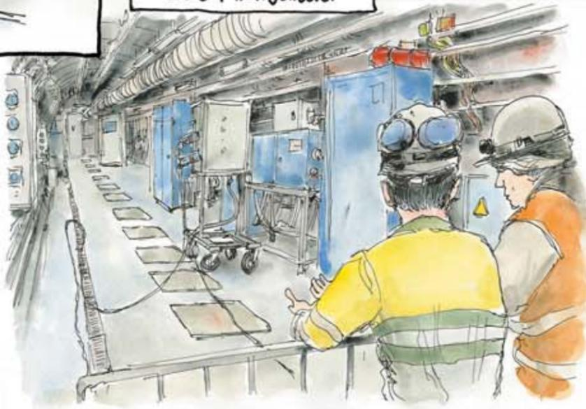
Dans ce tunnel, sous les trappes alignées sur le sol, ont été placés des échantillons de divers matériaux mis au contact de la roche afin d'observer leur réaction.
