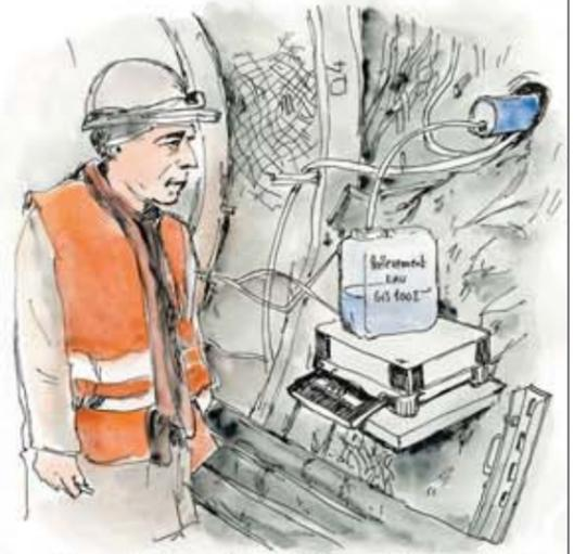
Pour stocker des déchets nucléaires, il faut un endroit sec. Même la roche argileuse, apparemment sèche, contient 18% d'eau. Parfois des forages drainent quelques gouttes d'eau, recueillies dans un bidon.
